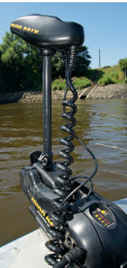
Der GPS-Empfänger des i-Pilot wird beim Umbau im Kopf des Elektromotors untergebracht
